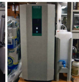
純水製造装置
